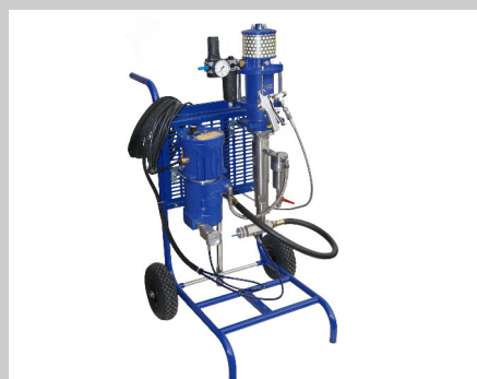
Heißspritzgerät / hot spray unit MX32 Vulkan MX32 Kolbenpumpe kombiniert mit dem Durchlauferhitzer Vulkan auf Breitwagen
